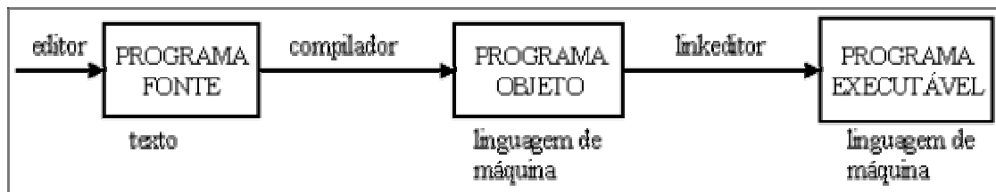
Figura 1: Etapas para Construção de um Programa Executável pelo Computador
